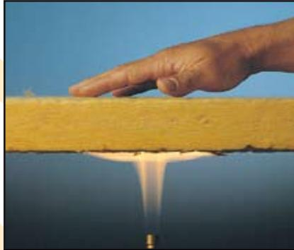
Unkaschierte SAGLAN Dämmstoffe sind unbrennbar.
